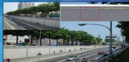
高雄地下道沉陷非破壞檢測
